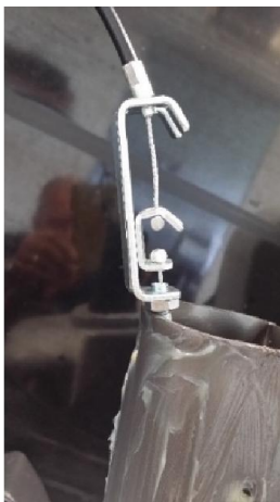
Správné zapojení regulátoru s bovdenem
