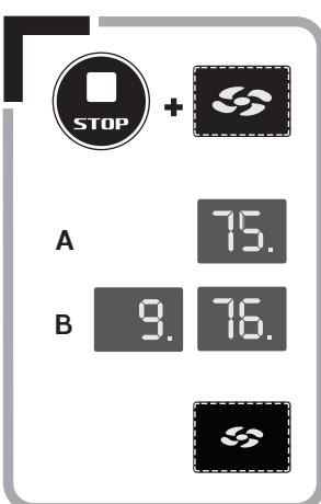
Чтобы просмотреть счетчик часов работы ламп, удерживайте одновременно нажатыми кнопки «стоп» и «Охлаждение тела больше» в течение 3 секунд.
