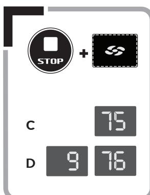
Общий счетчик часов работы солярия показывает полное количество часов работы аппарата, включая также время работы вентиляции. Счетчик можно просмотреть, удерживая одновременно нажатыми кнопки «стоп» и «Охлаждение тела меньше» в течение 3 секунд.
